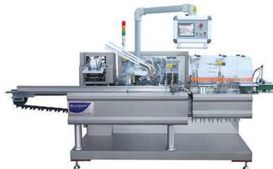
采用自动送料、开盒、入盒、打批号、封盒、剔废等的包装形式,结构紧凑合理,操作调整简单;人机界面显示,操作更清晰简便,自动化程度高,更具人性化;包装范围大,调节方便,各种规格尺寸之间可实现快速转换。
