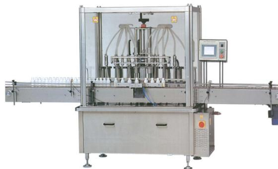
本机适用于各种不含气流体、半流体的定量灌装;自动完成计数进瓶、定量灌装、输送出瓶等一系列操作;特别适用于水剂、乳剂、悬浮剂、食用油、润滑油的定量灌装。是食品、医药、化妆品以及精细化工等行业的理想包装机械。
