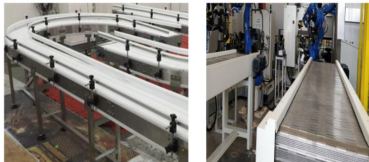
链板输送机可以满足饮料贴标、灌装、清洗等设备的单列输送的要求，同样也可以使单列变成多列并行走缓慢，从而产生储存量，满足杀菌机、储瓶台、冷瓶机的大量供料的要求。
