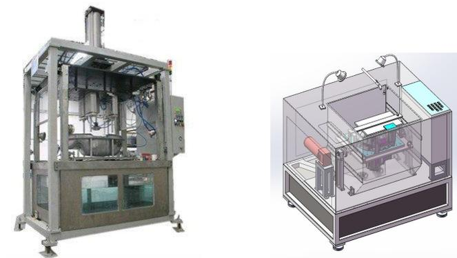
水检机主要是将被测件封堵后下沉入水中，由操作人员肉眼观察工件表面是否有连续性气泡。所有的元器件都为防水品，水箱四周为钢化玻璃，便于观察。
