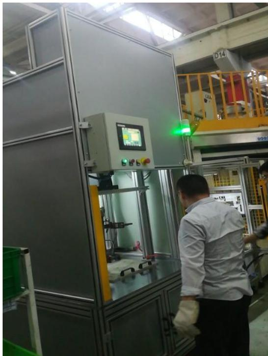
设备主要由主框架、激光刻标机、工件定位夹具三部分组成。
