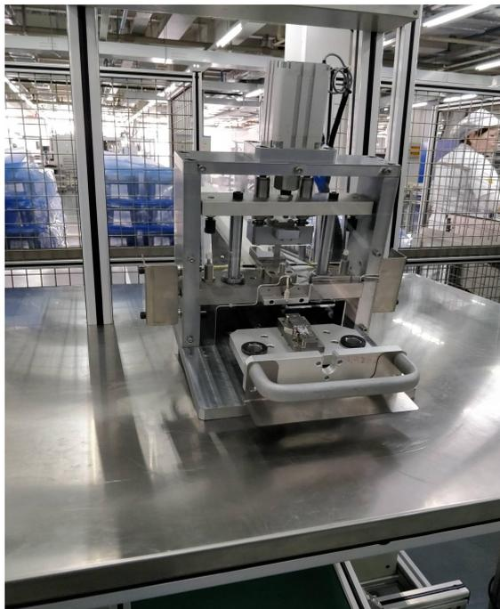
本机主要用于磁铁块的插入装配。设备操作简便，有自动和手动两种工作方式。
