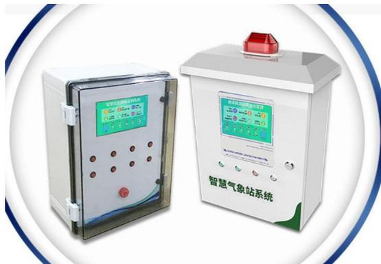
智能气象站是全电子气象设备，不同于传统的自动气象站，运用新科技对气象要素进行监测：集气象数据自动采集、自动存储、自动传输于一体的小型集成一体化气象站，同时采集10种气象参数：土壤温湿度，空气温度、相对湿度、风速、风向、雨量、太阳辐射及大气压力、PM2.5、PM10、TVOC，用户可在微信端\WAP端实时查看数据。
