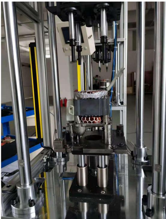
该设备主要用于电机定子的预紧，整个拧紧头为模块化快换结构，最多可以同时拧紧四个螺钉。
