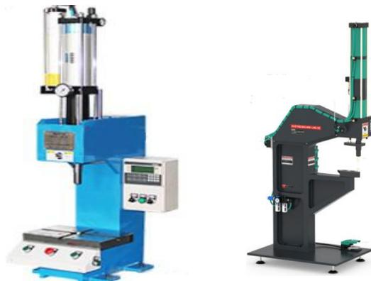
气液增压机采用气缸与液压缸以及电磁阀组作为动力执行元件。最大6bar或10bar压缩空气驱动，无需液压系统，即可产生2kN - 2000kN的冲击力，冲击力可在额定最大值以下无级调节。
