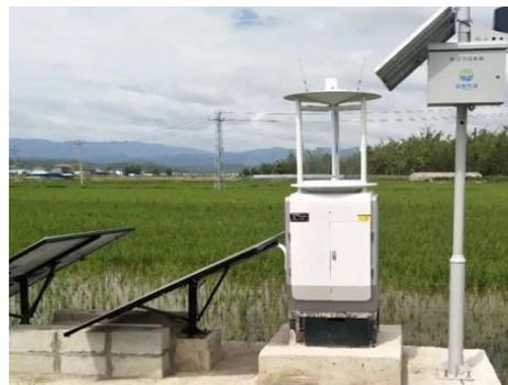
虫情监测系统集害虫诱捕和拍照、环境信息采集、数据传输、数据分析于一体。
