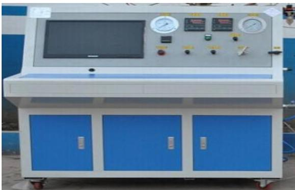
管件、阀体流量压力测试设备主要用于检测管件、阀门的气密性能、耐压强度、流量等。
