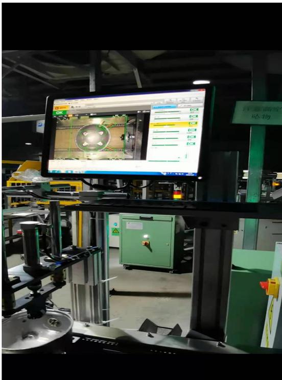
该设备主要由工件阻挡机构，视觉传感器和光源，工控机组成。
