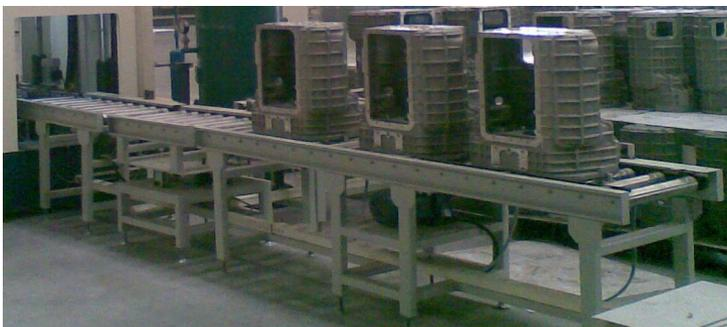
滚筒输送线适用于各类箱、包、托盘等件货的输送，能够输送单件重量很大的物料，或承受较大的冲击载荷，滚筒线之间易于衔接过滤，可用多条滚筒线及其它输送机或专机组成复杂的物流输送系统，完成多方面的工艺需要。
