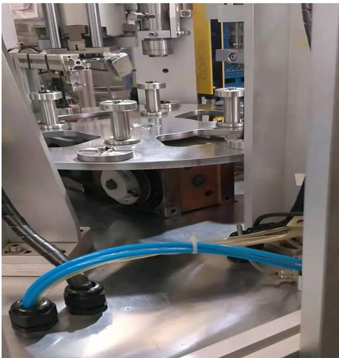
该设备采用四工位分度盘作为转位机构，工位1为取放料工位，工位2为压油封工位，工位3为压轴承工位，工位4为轴承铆点工位。
