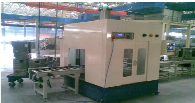
干式在线气密封检测设备，适用于管材，阀门、各类压力容器和壳体的在线气密性检测，设备根据客户需求非标定制，可用进口气密检测仪或我司自研的气密检测仪。
