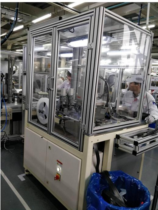
本设备主要由机架、飞达供料机构、校准机构、机器人搬运机构、折弯模块、下料转盘等几部分组成。
